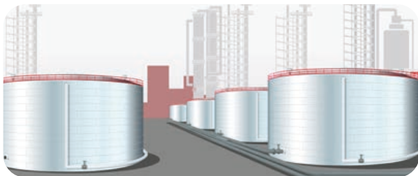
Резервуарный парк ЛВЖ, ГЖ
